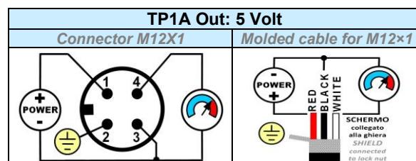
La numerazione dei pin si riferisce alla vista frontale del connettore maschio. / Pin numbering refers to male connector front view.
