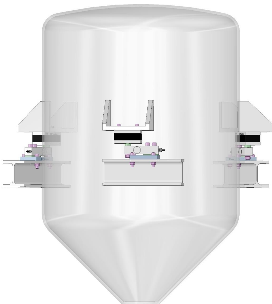
Silo a 3 punti di appoggio.
