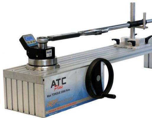
Permette di applicare il carico gradualmente in modo continuo, nel rispetto della normativa di riferimento UNI EN ISO 26789 (2017).
