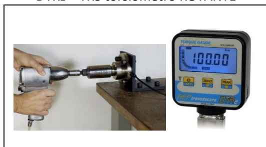
DTR2 + TRF torsimetro STATICO. Sistema per la taratura di avvitatori a massa battente
