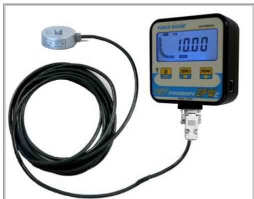
Per applicazioni particolari è possibile in OPZIONE avere il sensore del DFW2 e l'indicatore separati collegati tramite cavo.
